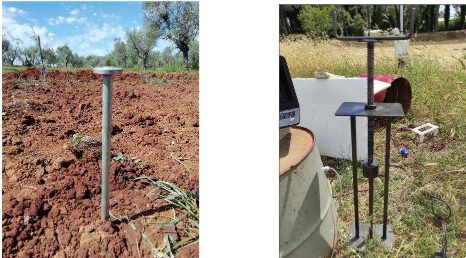
Figura 3 – Sonda ad asta, denominata puntazza, conficcata nel terreno ed estrattore
