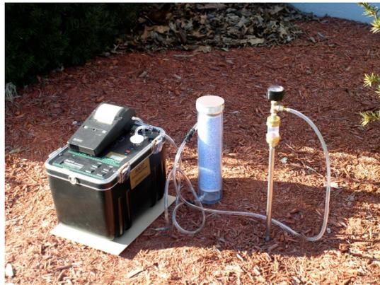
Figura 1 – Tecnica tradizionale di misura di Radon nel terreno
