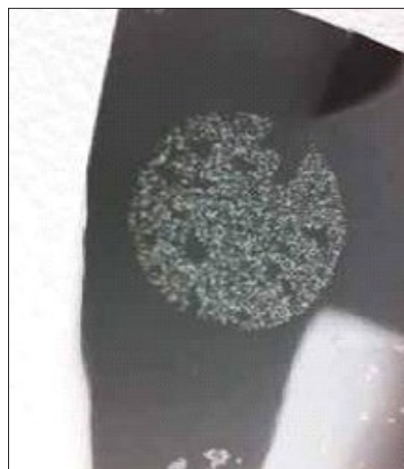
Replica dei fori dell'LR-115 sul foglio alluminizzato. Il sistema di conteggio permette di contare i buchi in qualche secondo
