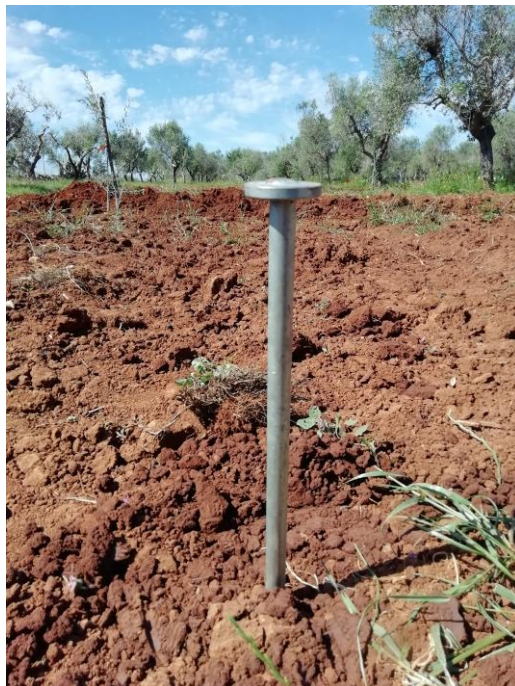
Figura 3 – Sonda ad asta, denominata puntazza, conficcata nel terreno
