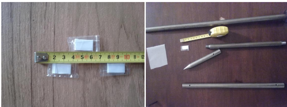
Figura 2 – (a) Dimensioni dei dosimetri utilizzati per le misure nel terreno; (b) Puntazza smontata con le tre cavità in cui sono collocati i dosimetri passivi
