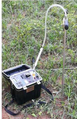
Figura 1 – Tecnica tradizionale di misura di Radon nel terreno
