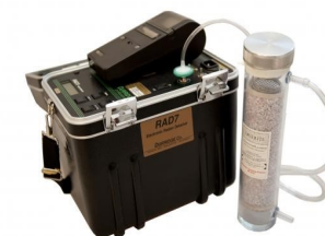
Rad7, per la misurazione attiva della concentrazione di gas radon in 24h.
