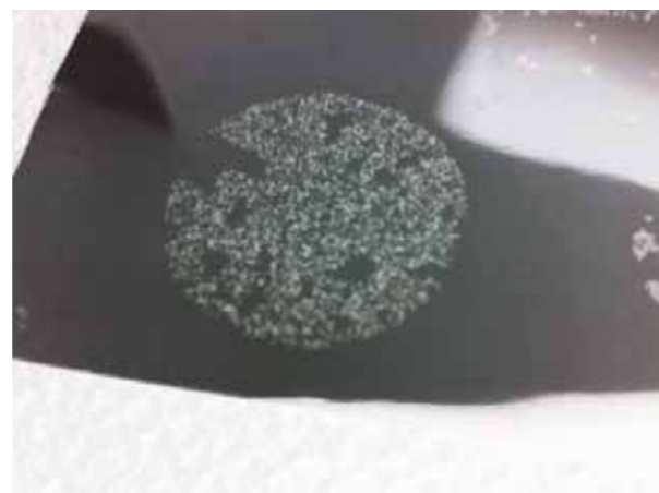
Replica dei fori dell'LR-115 sul foglio alluminizzato. Il sistema di conteggio permette di contare i buchi nel giro di qualche secondo.
